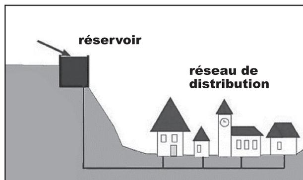
L'eau est envoyée vers les villes par des conduites de 2 sortes: les aqueducs dans lesquels l'eau coule par simple gravité et les feeders, conduites en acier ou en béton dans lesquelles l'eau est envoyée sous pression.
