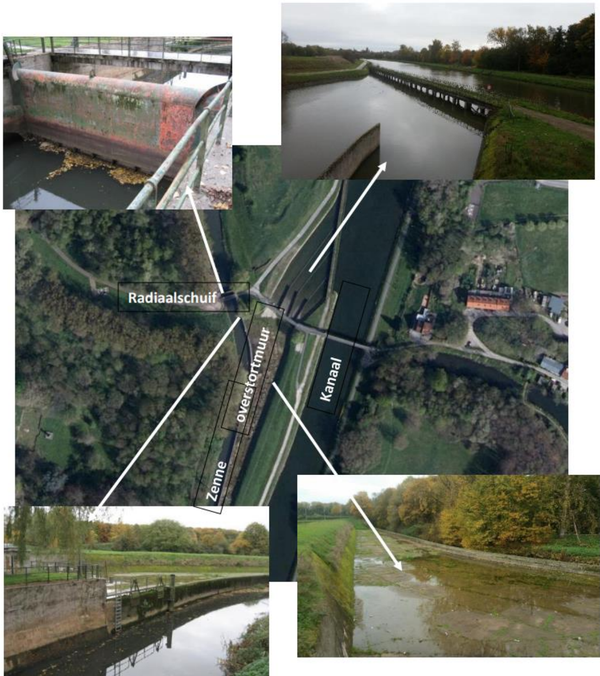
Figure 3 : Photos de la vanne radiale (déversoir) à Lembeek à des débits normaux, sans fonctionnement de la vanne et du déversoir
